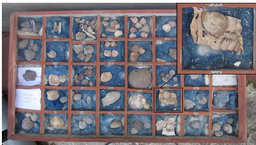
Figura 6. Cajón que contenía muestras de asbesto. Los filamentos, que se encontraban diseminados por todo el mueble, se agruparon y se aislaron.
