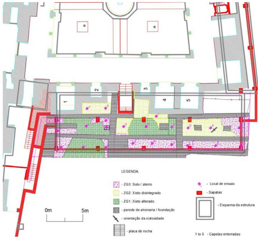
Figura 4. Zonamento geotécnico de uma escavação no Mosteiro do Lorvão (modificado de QUINTA-FERREIRA et al. , 2015b), baseado no reconhecimento geológico e na extrapolação espacial dos resultados dos ensaios.
