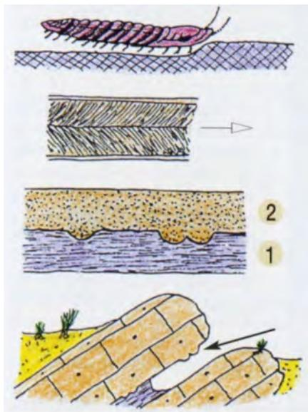
Esquema de la formación de huellas bilobuladas de tipo *Cruziana*, con relleno de arena que, tras la litificación, aparece exhumado en relieve inverso en la cara inferior (flecha) de los bancos de areniscas o cuarcitas.
